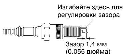
Рис. 12. Регулировка зазора свечи зажигания, нагреватель мощностью 10 кВт
