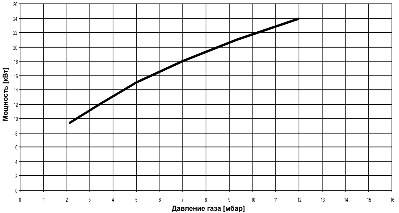
Мощность CGG-1K-24 природный газ Данные при давлении воздуха 1013 мбар и температуре газа 15°C
