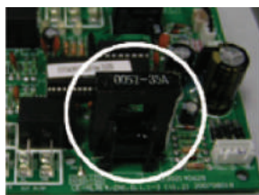
Защита компрессора по току
