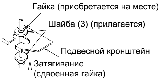
[Закрепление подвесного кронштейна]
