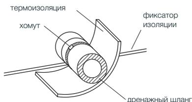
Место соединения должно быть изолировано теплоизоляционным материалом.
