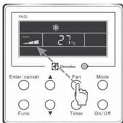
Во включенном/выключенном состоянии внутреннего блока нажимайте кнопку Вентилятор для изменения скорости вентилятора в следующей последовательности.
