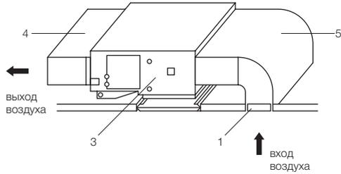
При подключении воздуховода снизу необходимо снять пластину-заглушку и установить на ее место прямоугольный фланец. Пластина-заглушку следует установить с торца на место фланца.
