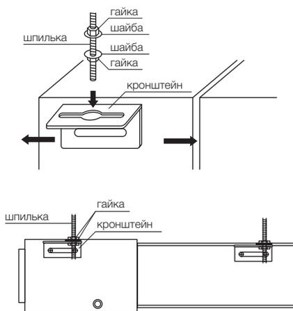
3. С помощью гаек зафиксируйте блок на шпильках анкерных болтов.
