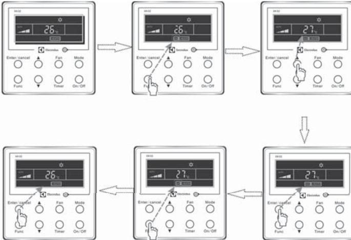
**Установка энергосберегающего режима для обогрева**
