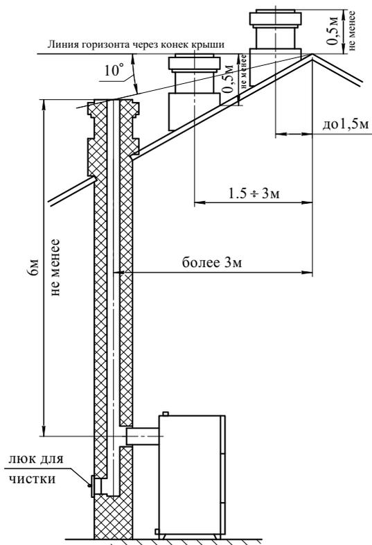
**Рис. 7** Варианты установки дымовой трубы
