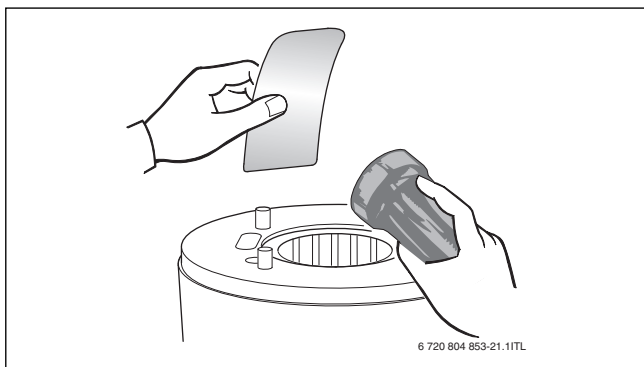
Рис. 52 Проверка наличия грязи в теплообменнике
