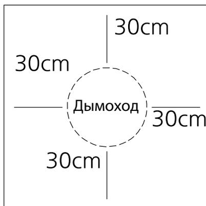
При повышении мощности во время эксплуатации котла температура дымохода может повышаться, поэтому любая близость горючих материалов к трубе дымохода пожароопасна и может стать причиной пожара.
