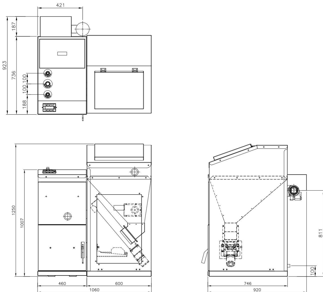
Рисунок 14. Габаритные и присоединительные размеры для котлов KRP-20
