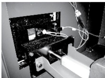
Рисунок 13 Устройство очистки колосника
