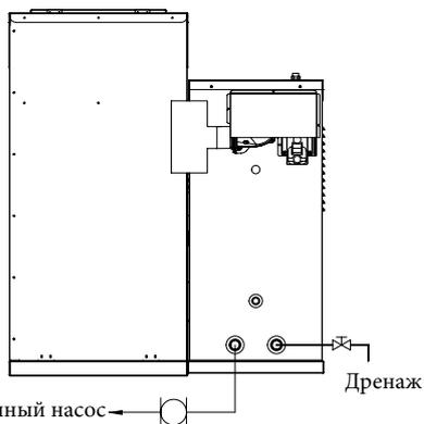
Циркуляционный насос должен соответствовать мощности котла и объёму теплоносителя в системе отопления.
