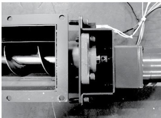
Рисунок 8. Привод винтового транспортёра пеллет
