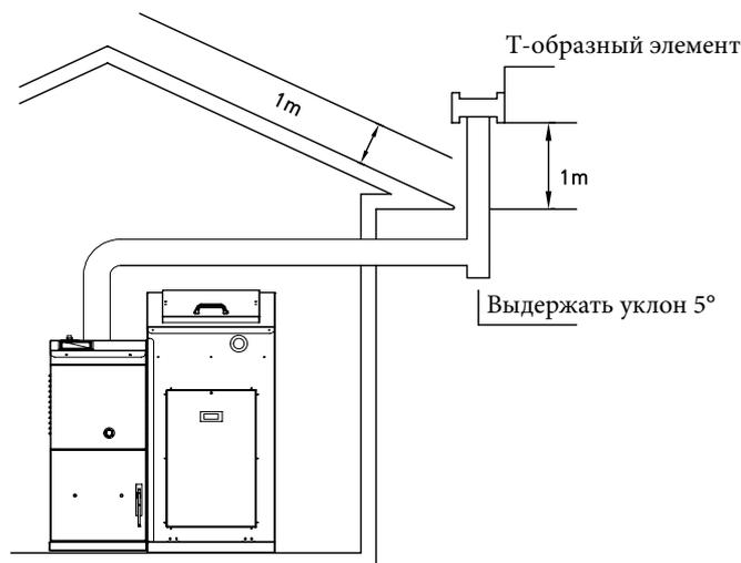
Выход дымохода должен быть примерно на 1 метр выше крыши и рядом находящихся строений.
