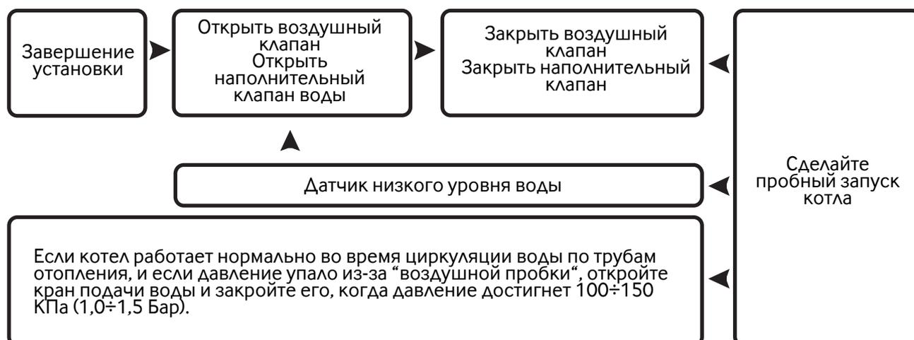
Закройте наполнительный клапан при запуске котла. Если наполнительный клапан открыт при запуске котла, могут возникнуть следующие неисправности:
