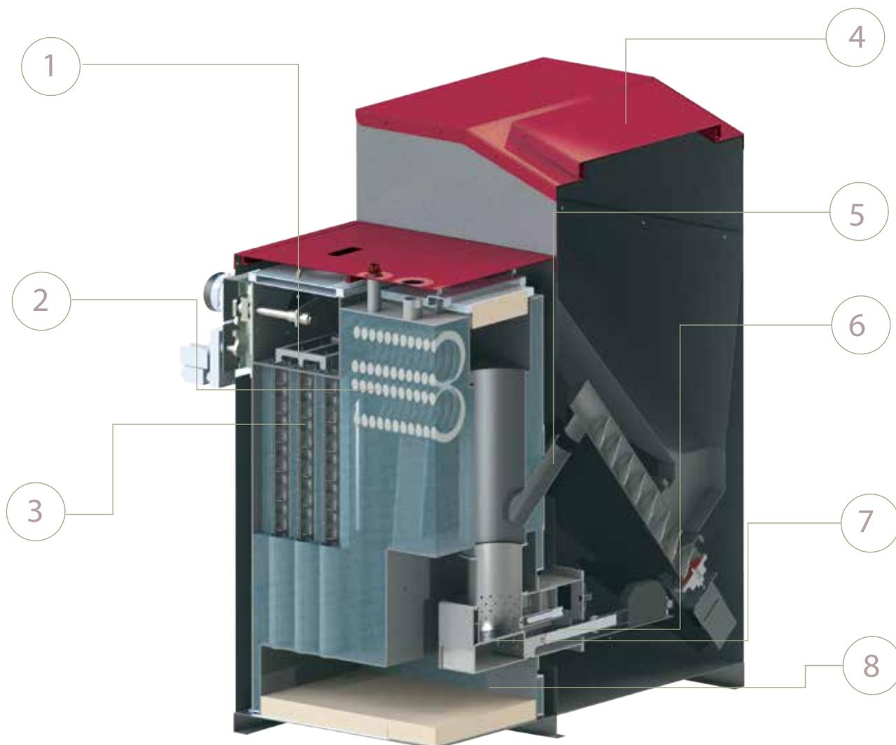
Рисунок 3. Функциональях схема котла
