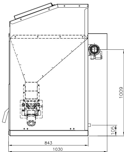
Рисунок 15 Габаритные и присоединительные размеры для котлов KRP-50
