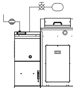
При превышении в водопроводной сети входного давления более  $6 \text{ кг/см}^2$ , установить редуцирующий клапан.
