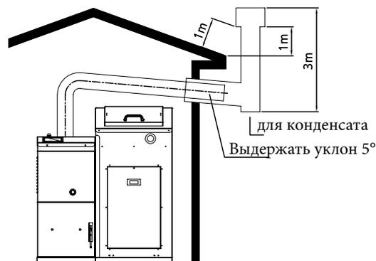
Высота дымохода должна быть не менее трёх метров выше установленного котла. На конце дымохода для ветрозащиты установите Т-образный элемент
