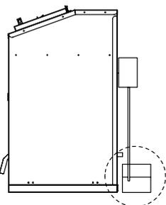
Предусмотрите подключение конденсатосборника. Для предотвращения пожара, конденсатосборник и присоединительный шланг должны быть термоизолированы.
